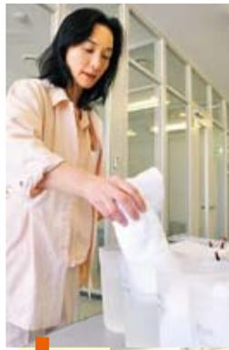
洗剤の残り香を評価する場面。香りの濃度や種類が異なる洗剤液に浸したタオルを洗濯乾燥させ、それぞれの香りの強さを調べる。
