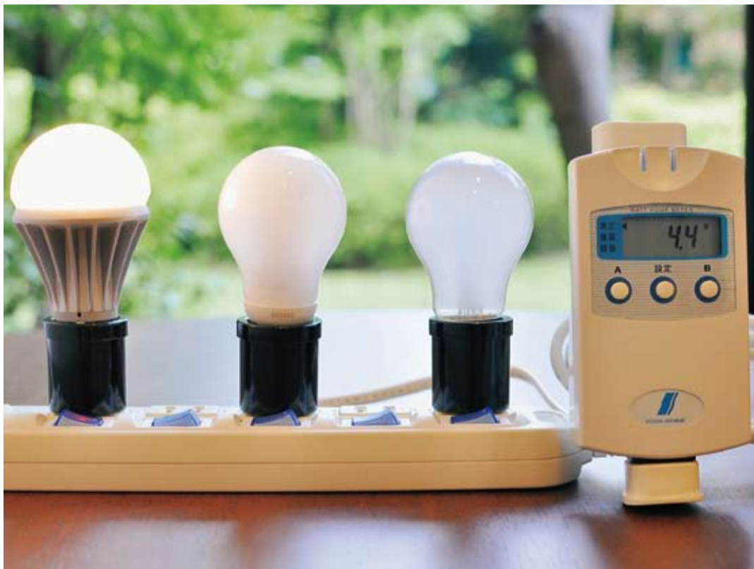
▲左からLED電球、電球型蛍光灯、白熱灯。写真はLED電球の消費電力をワット アワーメーターで測定しているところです
