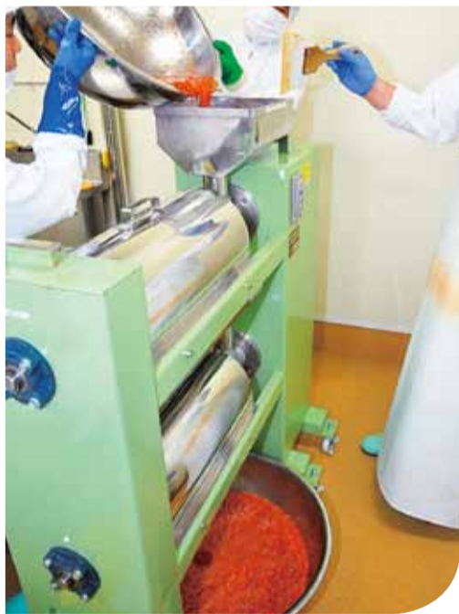
パルパーフィニッシャーは、煮たトマトを上から注ぐと、銀色の円筒形の部分で搾られる仕組みだ
