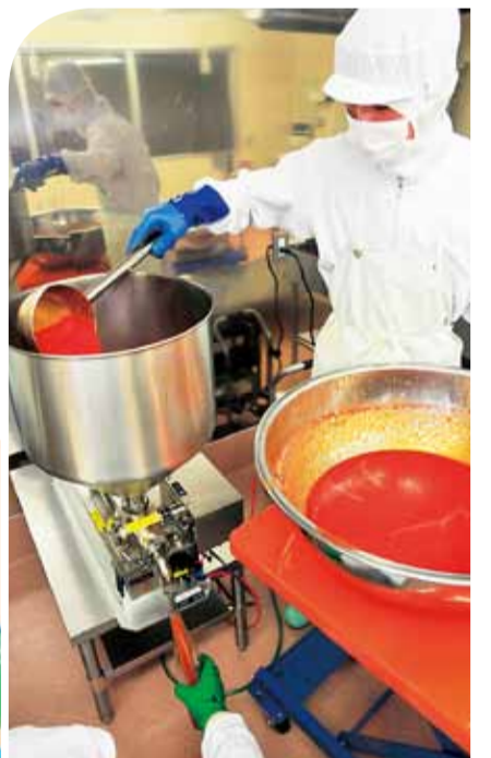
瓶に詰める作業。ペダルを踏むと、定量が自動的に注入される
