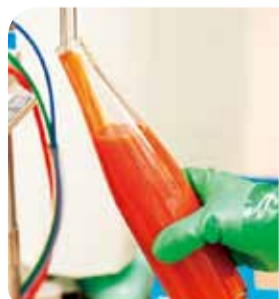
瓶に詰める作業。ペダルを踏むと、定量が自動的に注入される
