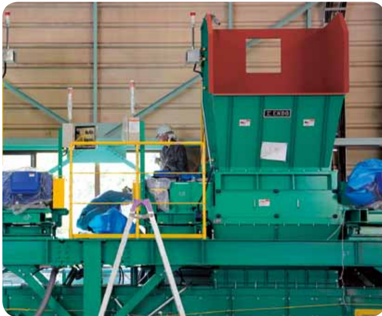
剪定枝をチップ化する破砕機。稼働に向け、着々と整備を進めています。
