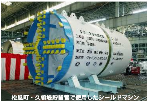
松風町・久領堤貯留管で使用したシールドマシン
