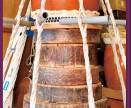
①太鼓作りの第一歩。皮をなめして②1週間ほど室外で乾かします③台の上に太鼓を置き、ロープを掛けて④パイプで絞りを⑤木づちで叩いて締めていきます⑥「さらに強く締めるために皮を踏みます。結構力が要りますよ」と岡田さん⑦締めが足りない場合はくさびを打ちます。⑧鋏を打ってロープを外して無事完成(⑨)⑩作業は夜まで続きました。
