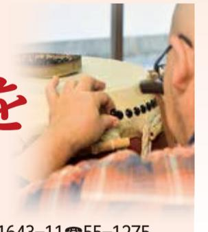
ガツン、ガツン……。清水屋太鼓店の店内に、木づちを打ち付ける音が重く響き渡ります。冬の訪れを肌で感じる12月9日、大太鼓の皮を締める作業をする同店の3代目店主、岡田有弘さん（1面写真）の額に浮かぶのは大粒の汗。息を切らしながら、木づちを振り下ろします。「締め太鼓という小さな太鼓の皮はお客さまが自分で締めますが、大太鼓は私が締めて引き渡します。納得する音が出るまで、何回でも締め直しますよ」と話す岡田さん。「求められる音は同じ市内でも地域によって大きく違うので、依頼主と自分の両者が納得できるまで丹念に調整します」と熱を込めます。
