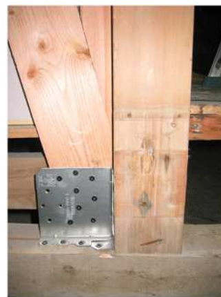
2倍金物(金物あり) F_w=2.4\text{ kN/m}
