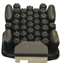
エアセルと呼ばれるゴムのクッションが何個も付いています。座った時に空気が抜け、お尻が底付きする手前でセンサーが検知。その後、適正な体圧を維持するための空気が適量、各セルに送り込まれます。座った時の安定性を確保し、長時間でもその座り心地を維持できます。
