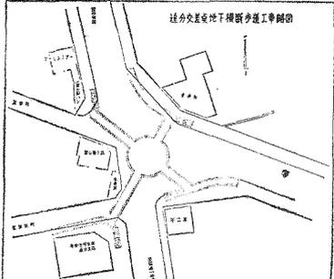
この歩道は、追分交差点の中心部を貫通し、東西の両側に歩道を設ける。中央には直径10メートルの噴き水ロータリーを設け、歩道は階段とスロープを併用して、地下と地上を結ぶ。
