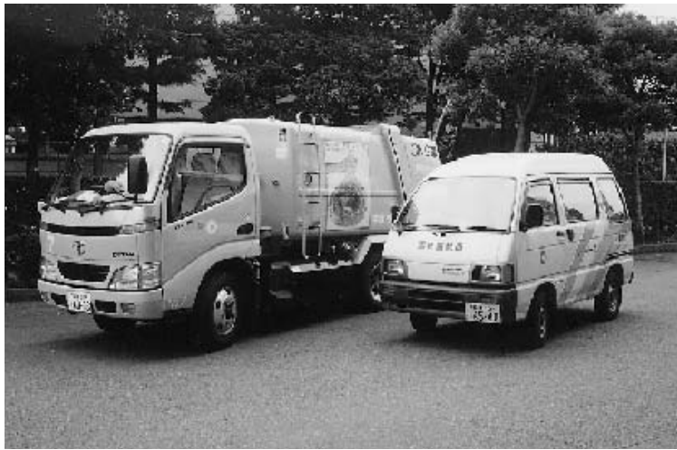
環境に優しい天然ガス車(CNG車)と電気自動車
