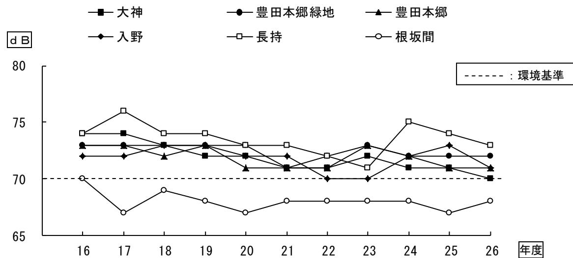
図3-8 新幹線振動測定結果経年変化
