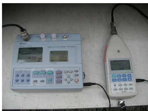
測定機器（左：振動計 右：騒音計）
