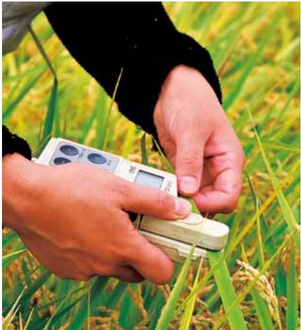
(上)80種類以上の稲が育つ試験水田(下)専用の計測器を使い、葉の色を調べます。葉の色から肥料の効果が分かります
