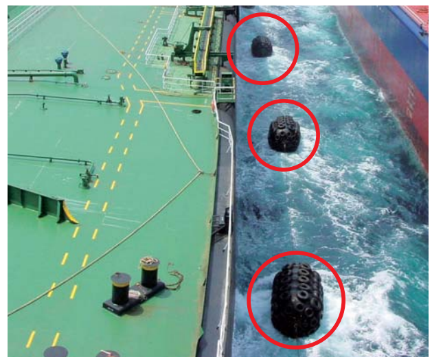
タンカー同士の間に浮かべ、2隻が接岸する時の衝撃を和らげます。赤い丸印が防舷材
