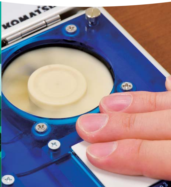
ケルケ KELKの熱電素子を利用した 手の熱で回るモーター
