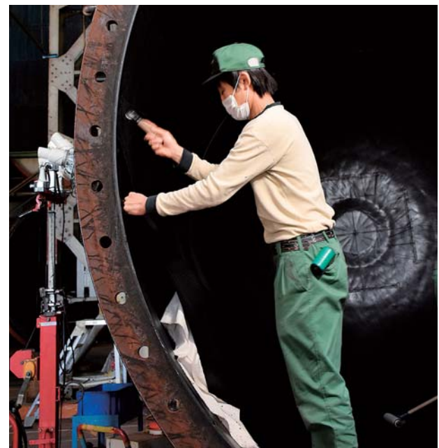
製造は手作業で進められます。金属製の型の内側にゴムを丁寧に貼り付けていきます
