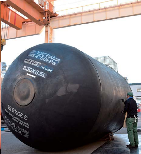
横浜ゴム平塚製造所の空気式防舷材。 大型船などで使われます
