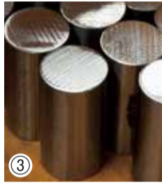
①特殊な円形の刃が付いた機械で金属素材を切断していく。高い技術力を信頼して、派遣後に任されるようになった新たな仕事②長さが正確か確認。36ミリのぴったり③④切断面の角を削り、きれいな部品が完成
