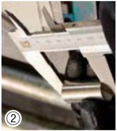
①特殊な円形の刃が付いた機械で金属素材を切断していく。高い技術力を信頼して、派遣後に任されるようになった新たな仕事②長さが正確か確認。36ミリのぴったり③④切断面の角を削り、きれいな部品が完成
