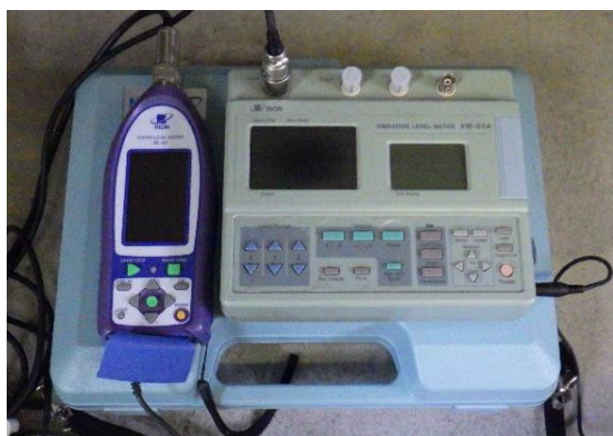
測定機器（左：騒音計 右：振動計）
