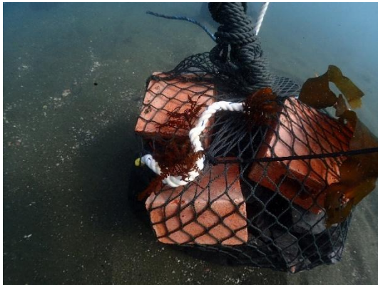
Fig. 33 試験体へ直接取付 (アカモク)
