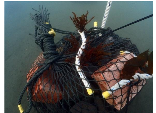
Fig. 23 試験体へ直接取付 (アカモク)
