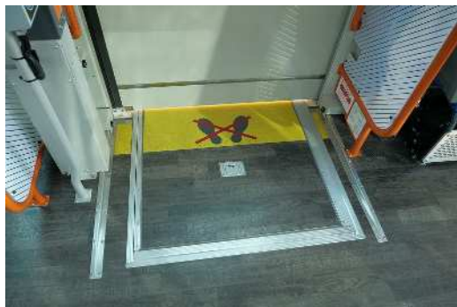
車いす等対応スロープ収納箇所（エルガEV）
