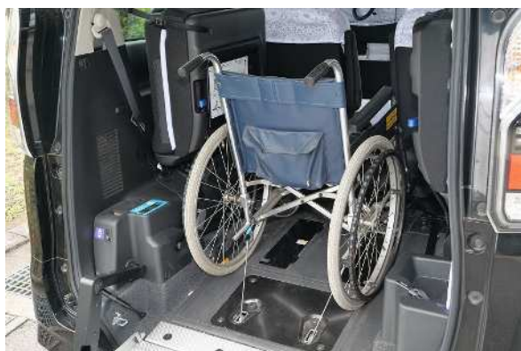
車いす固定状況
