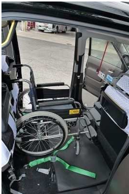
車いす固定状況
