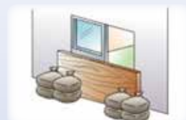
板やテーブルと土のうで 作る止水板
